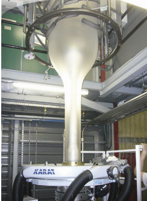
Pierścień chłodzący KARAT 2 do produkcji folii HDPE na wysokim balonie
